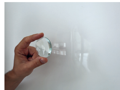
Photographie témoignage, la loupe est placée à la distance optimale du mur pour faire le focus et projette alors l'image de la salle retournée, telle une Camera Obscura.
